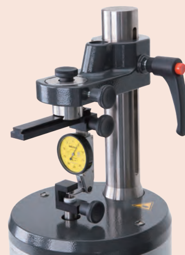
Kalibrering av vippindikator med specialtillbehör
