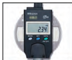
Bredd 35 mm i stället för 60 som standard Digimatic mätur
