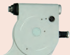
Justerskruv för mätur ± 5 µm
