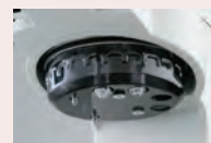
Motoriserad växlare med fäste för 2 indentrar och 4 objektiv
