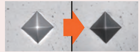
Betraktningssbild av intrycket (50X) Reducering av ströjlus runt intrycket
